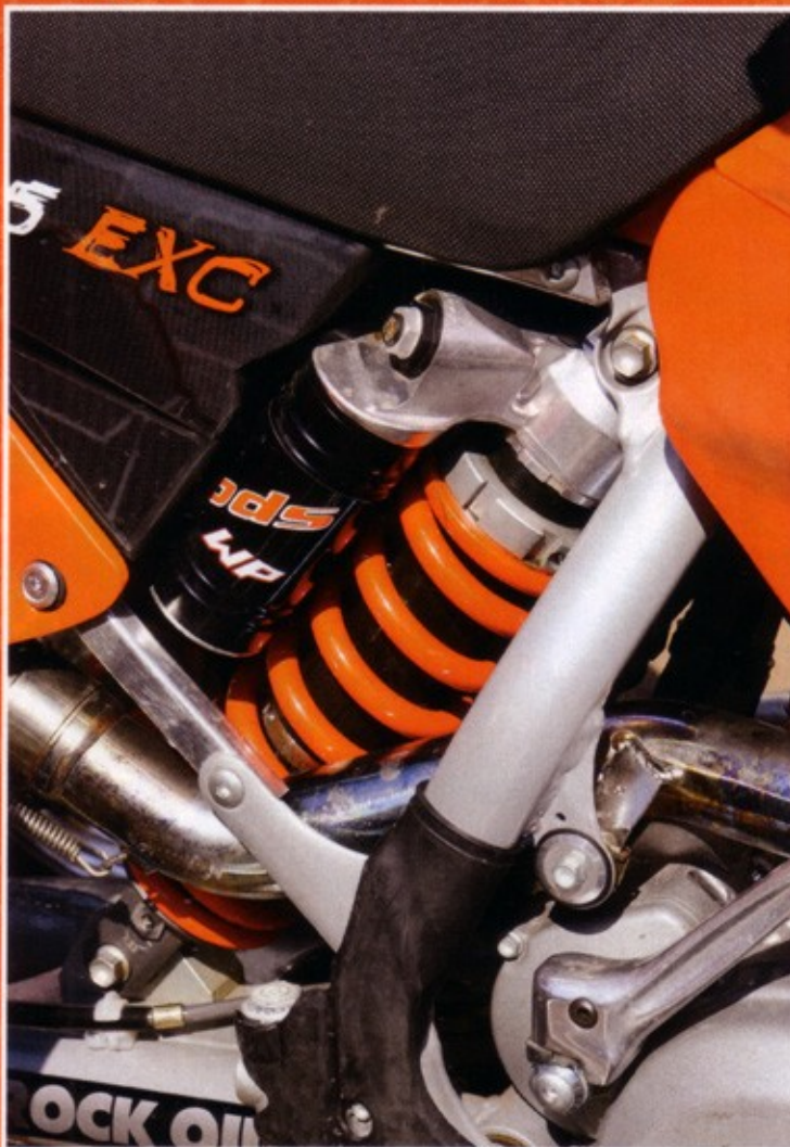
Dank zahlreicher Einstellmöglichkeiten für jede Situation gerüstet: White Power Heckdämpfer in PDS Bauweise
