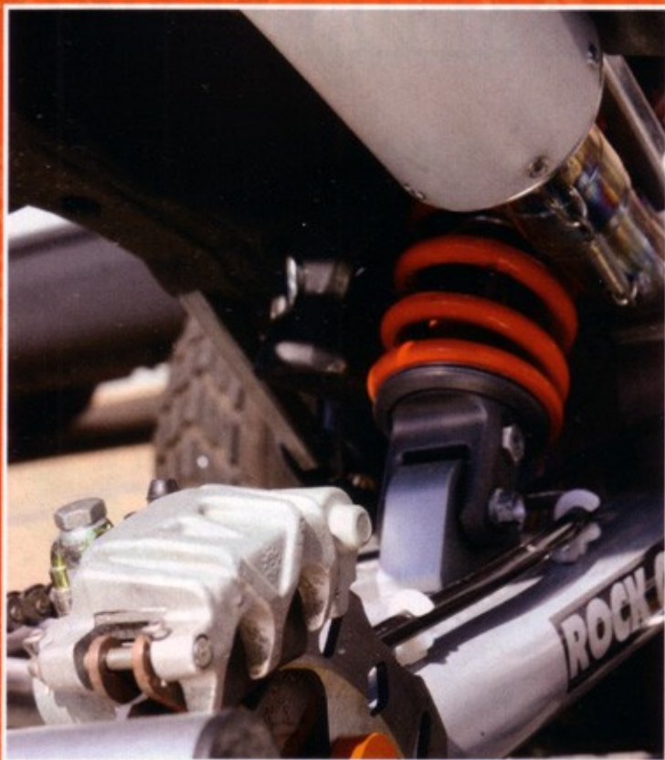
Der Auspuff setzte beim Springen auf dem Bremsattel auf. Dadurch löste sich die Hohlschraube mit der die Bremsleitung befestigt wird
