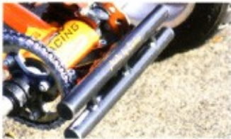
Ein Stummelstoßstange schützt Antriebsstrang und hintere Achse
