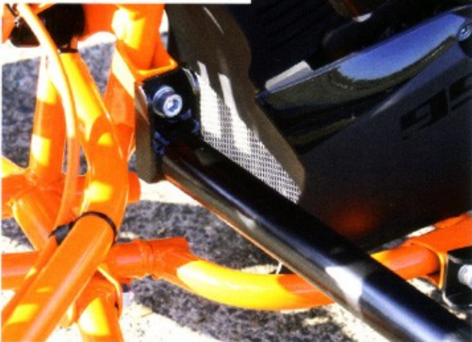
Der Motor der E.-ATV wird an der Front durch ein Metallgitter geschützt
