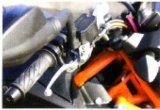
Motorradlike - Gas gegeben wird per Drehgasgriff
